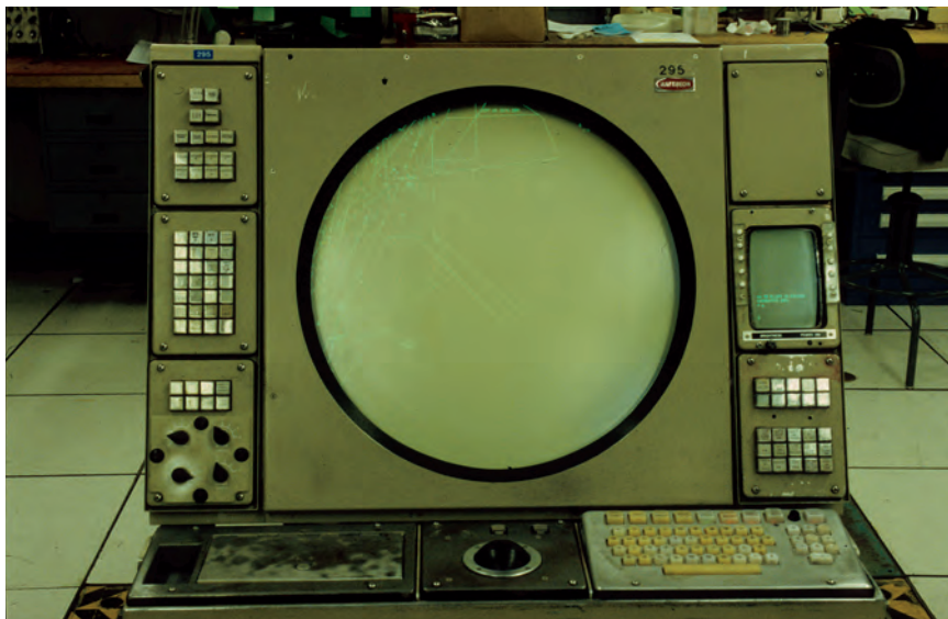
Consola de Control de Tráfico Aéreo, en uso hasta la década de 1990. El sistema de Control de Tráfico Aéreo de Estados Unidos compartía muchas características con el sistema de defensa aérea SAGE. Debido a la gran inversión inicial que hizo Estados Unidos en estos sistemas, permanecieron en uso aun cuando estaban ya técnicamente obsoletos. Esta pantalla circular de radar, derivada de un sistema de defensa de la Segunda Guerra Mundial, se empleó en control de tráfico aéreo comercial en Estados Unidos hasta entrada la década de 1990. Smithsonian Institution.
